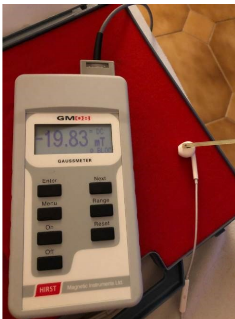
Figura 13.2 – Misura campo statico auricolare
