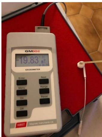
**Figura 13.2 – Misura campo statico auricolare**
